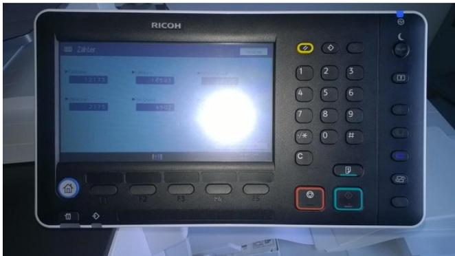
2. Drücken Sie die „Zählerstandstaste“.
